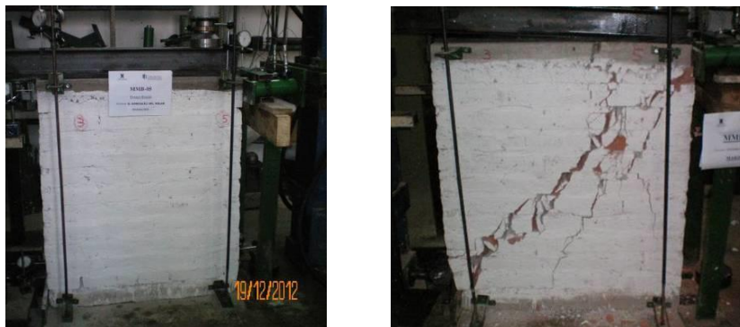
Figura 2. Probetas ensayadas a compresión diagonal (antes y después del ensayo).
