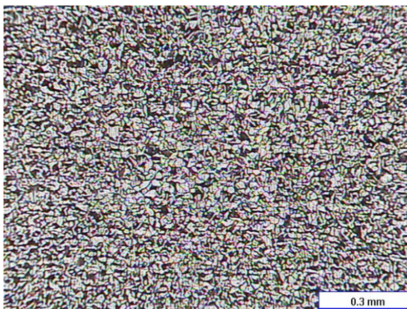
Figura 4. Microestructura del acero al carbono a100X.
