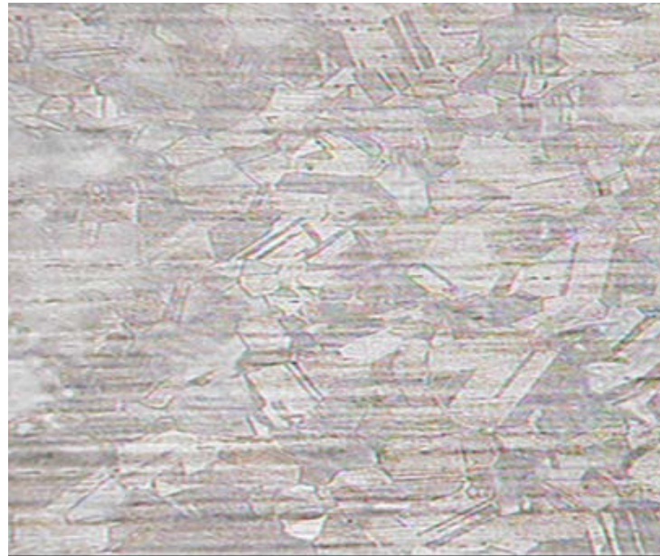
Figura 5. Microestructura del acero inoxidable AISI 304 a 100X.
