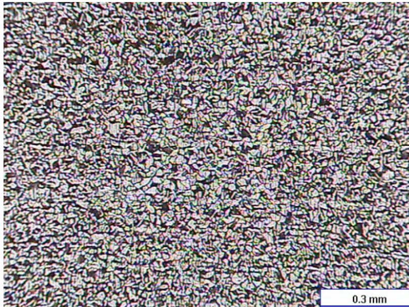
Figura 4. Microestrutura do aço carbono a 100X.
