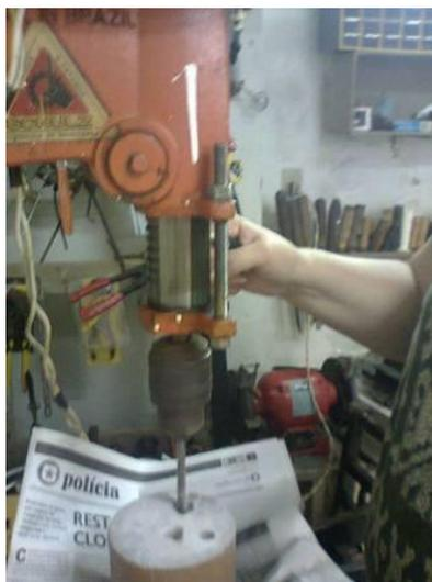
Figura 4. Ensaios de perfuração com furadeira fixa.
