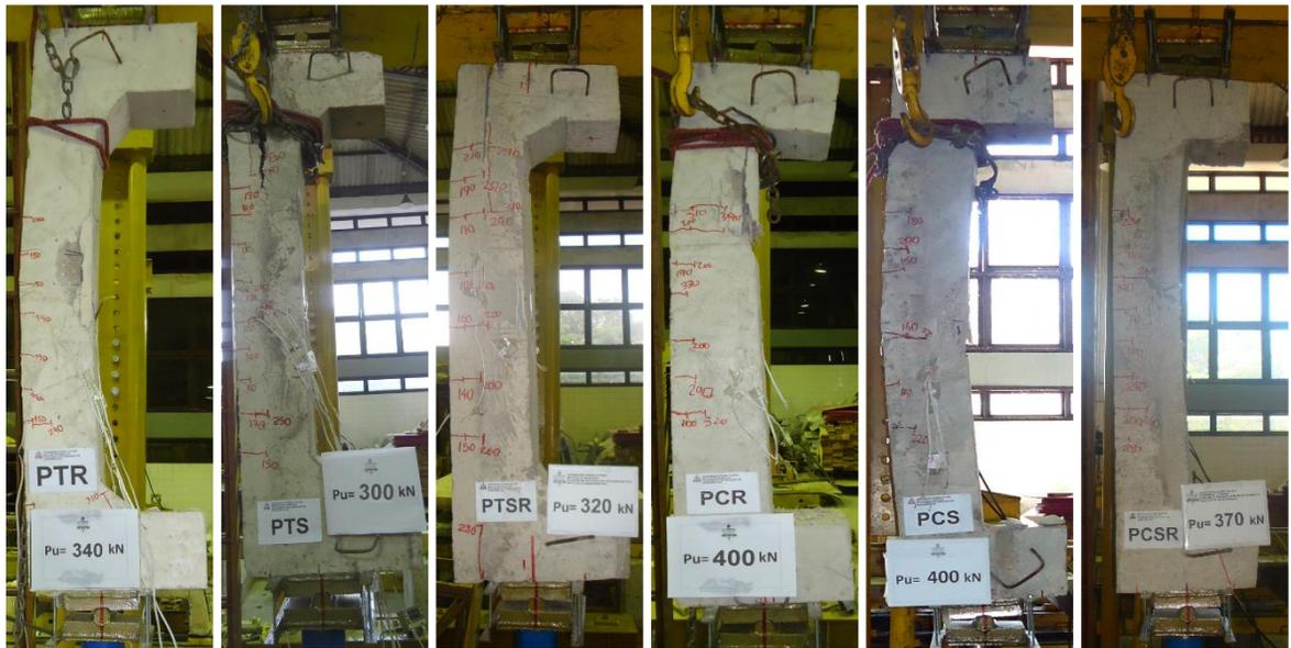
Figura 10. Pilares após a ruptura.
