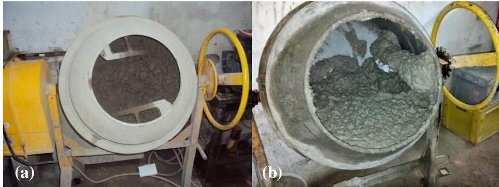
Figura 1. Mistura dos materiais em betoneira. Sem aditivo incorporador (a) e com aditivo incorporador (b).
