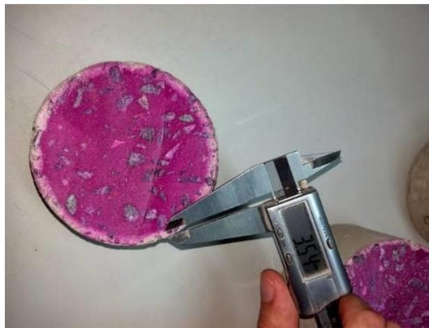
Figura 11. Medição da profundidade de carbonatação para massa específica de 1700 kg/m<sup>3</sup>
