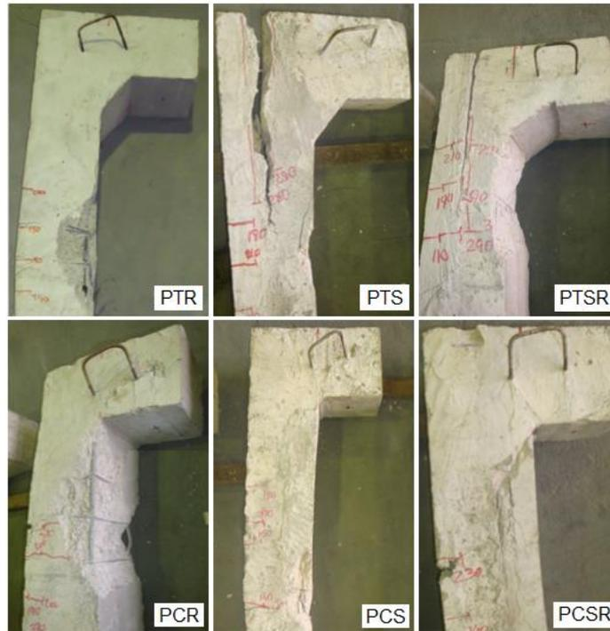
Figura 11. Detalhe dos pilares após a ruptura.
