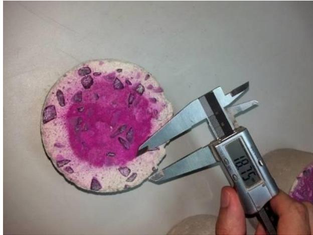
Figura 10. Medição da profundidade de carbonatação para massa específicas de 1500 kg/m<sup>3</sup>
