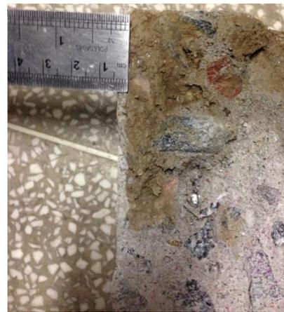
Figura 13. Exemplo da medição da profundidade penetrada por cloretos na amostra fraturada
