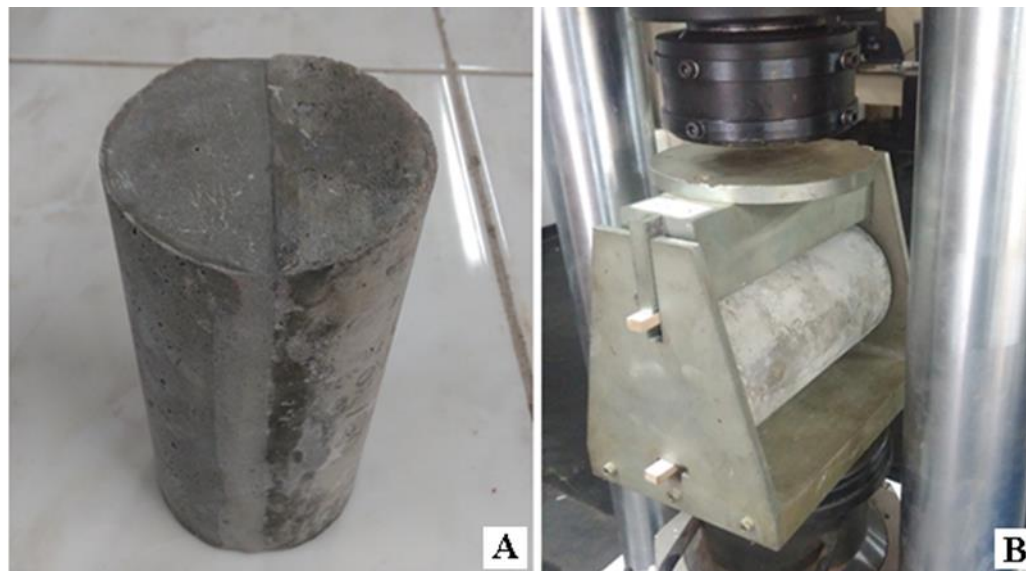
Figura 3. (A) Corpo de prova para determinação da aderência entre o reparo e o concreto; (B) Ensaio para determinação da aderência entre o reparo e o concreto por compressão diametral
