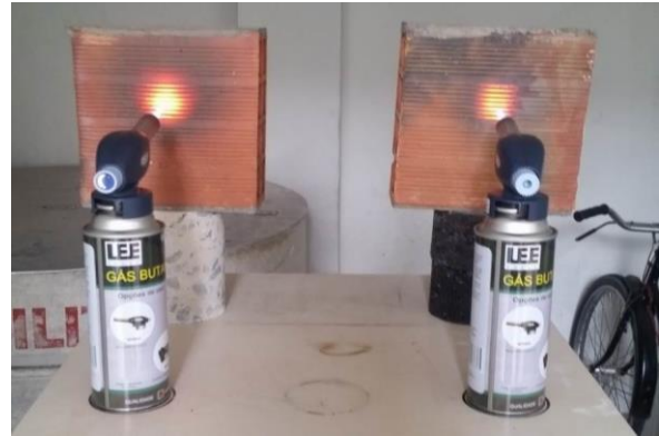
Figura 7. Bloques sin protección pasiva.
