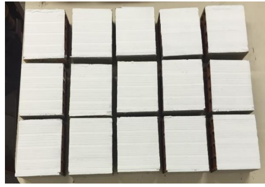
Figura 4. Aplicación de tinta intumescente.
