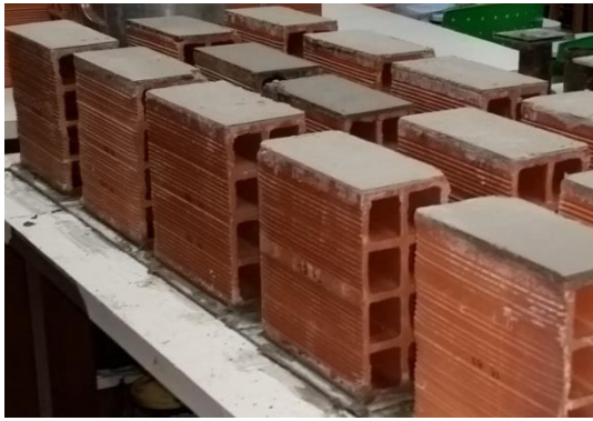
Figura 3. Copeamiento de bloques cerámicos.
