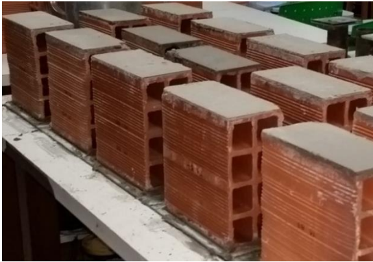
Figura 3. Capeamento dos blocos cerâmicos.
