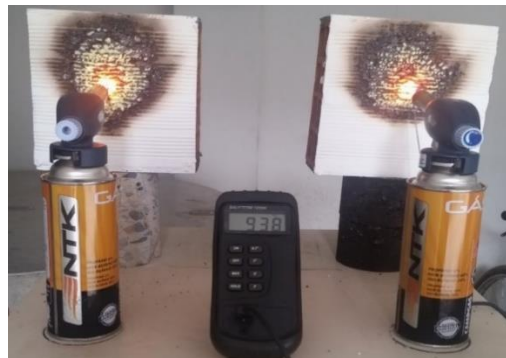
Figura 5. Aplicação da tinta intumescente
