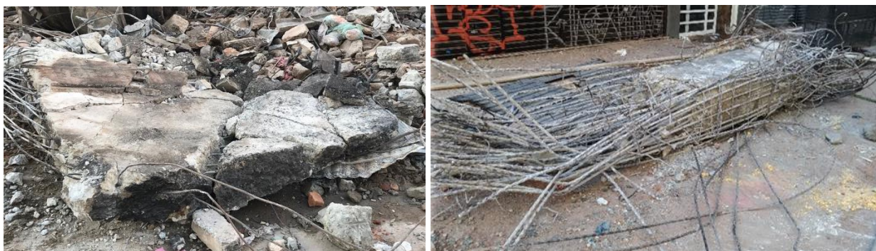
Figura 10. Trechos de laje em balanço e pilar recolhidos dos escombros para ensaios (fonte: acervo pessoal de Paulo Helene)
