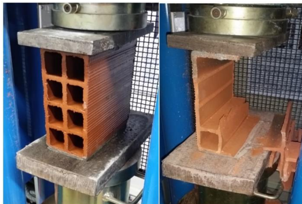
Figura 6. Resistência à compressão.
