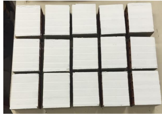
Figura 4. Aplicação da tinta intumescente.
