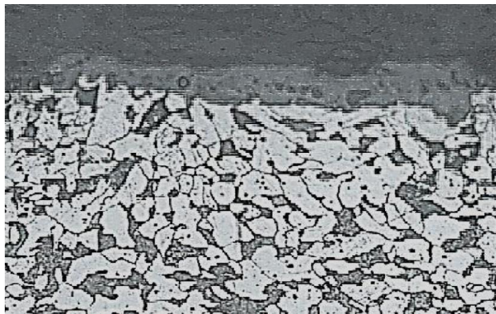
Figura 15. Superfície da amostra de barra de aço com 22mm de diâmetro, 200x ampliada (Fonte: Laboratório da ArcelorMittal)
