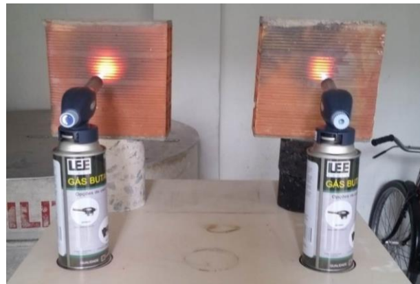
Figura 7. Blocos sem proteção passiva.
