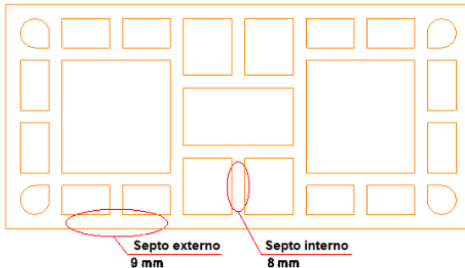
Figura 8. Paredes internas e externas dos blocos.
