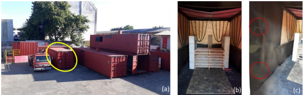
Fig. 2. Simulador escolhido (a), dispositivo montado (b) e disposição dos sensores (c)
