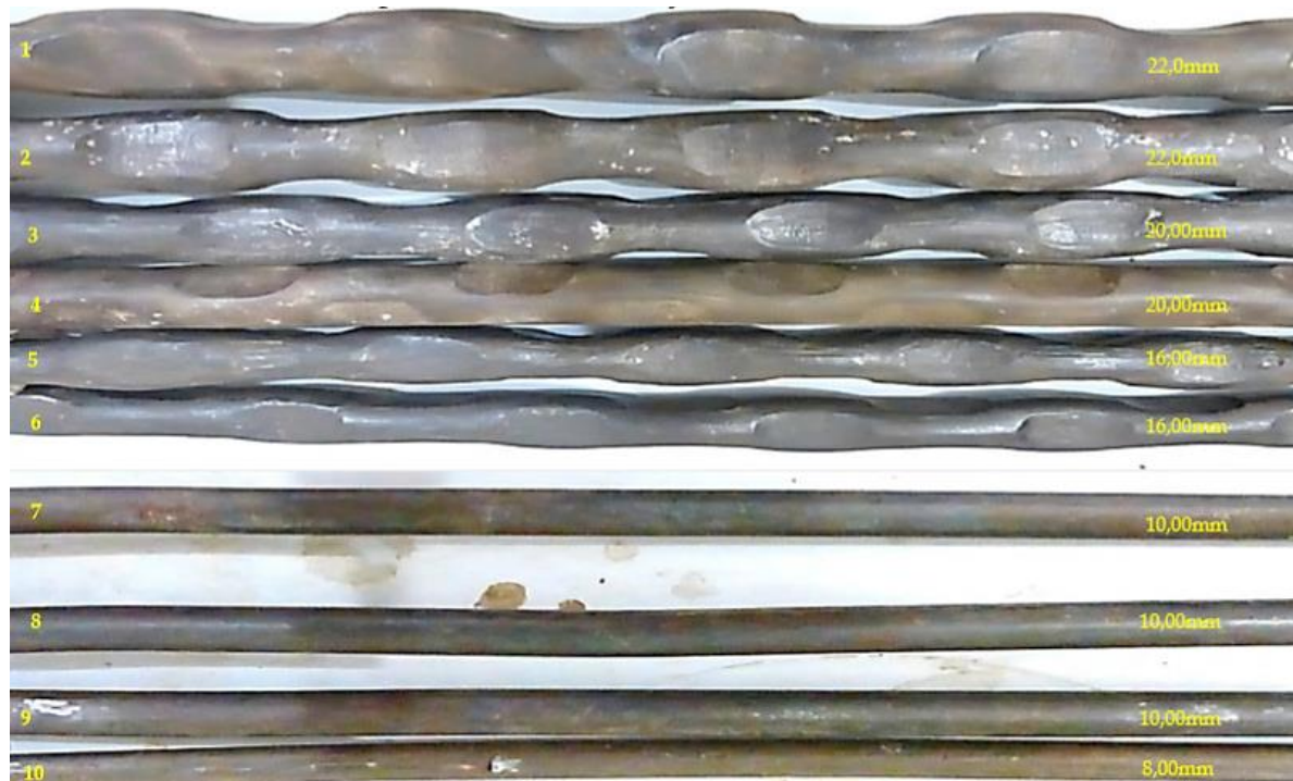
Figura 14. Classificação das amostras de aço de acordo com sua bitola (fonte: Arcelor Mittal)
