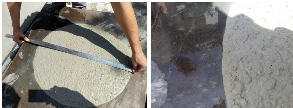
Figura 3. Detalhe do ensaio de espalhamento realizado em laboratório durante o estudo de dosagem.
