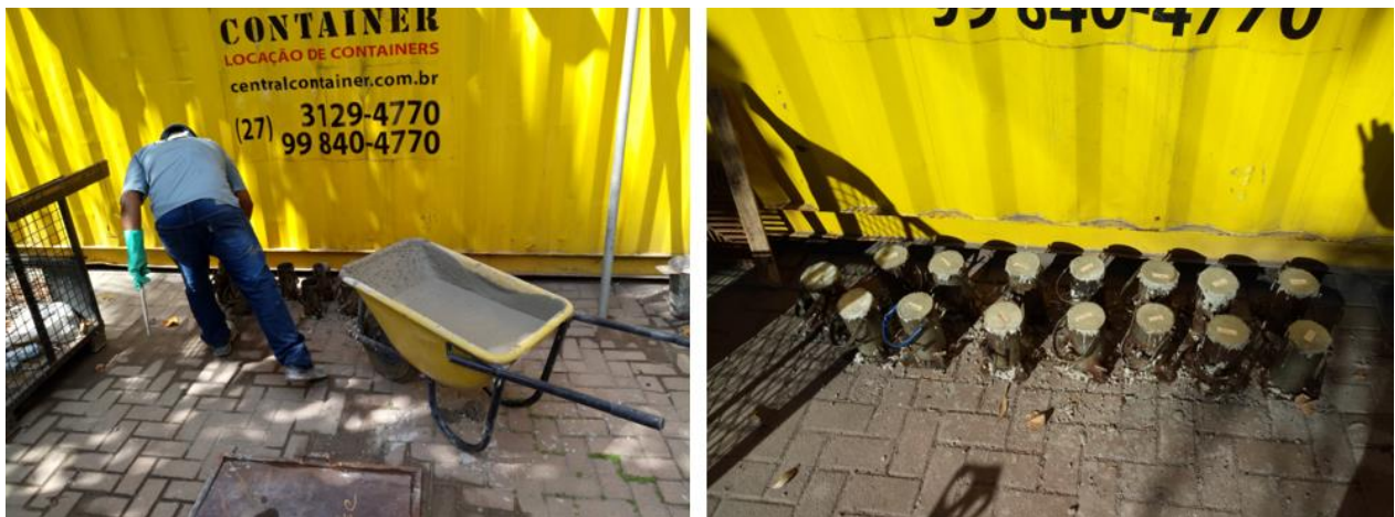
Figura 6. Detalhe da moldagem de corpos de prova cilíndricos no evento de concretagem protótipo para ensaios de resistência à compressão e módulo de elasticidade.
