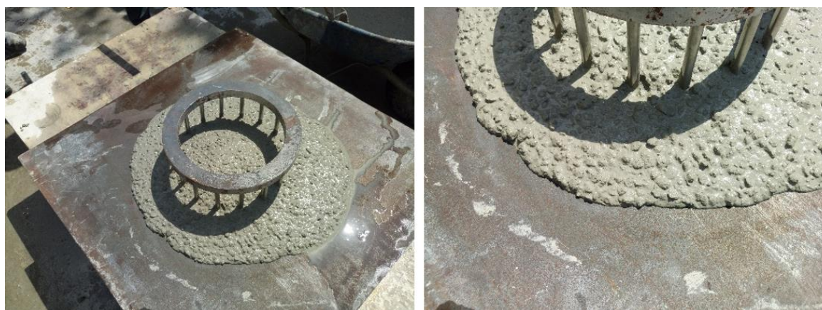
Figura 5. Detalhe do ensaio de habilidade passante através do anel J, realizado em laboratório durante o estudo de dosagem.
