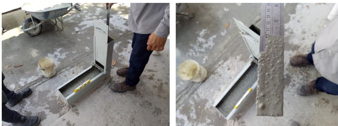
Figura 4. Detalhe do ensaio de habilidade passante através da caixa L, realizado em laboratório durante o estudo de dosagem.
