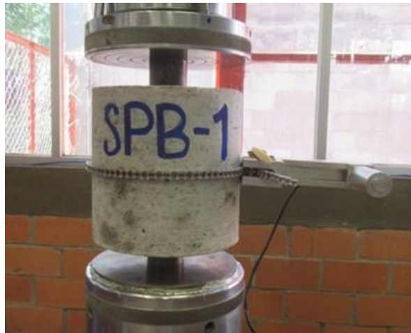
Figura 11. Ensaio de dupla punção, configuração, UNE 83515
