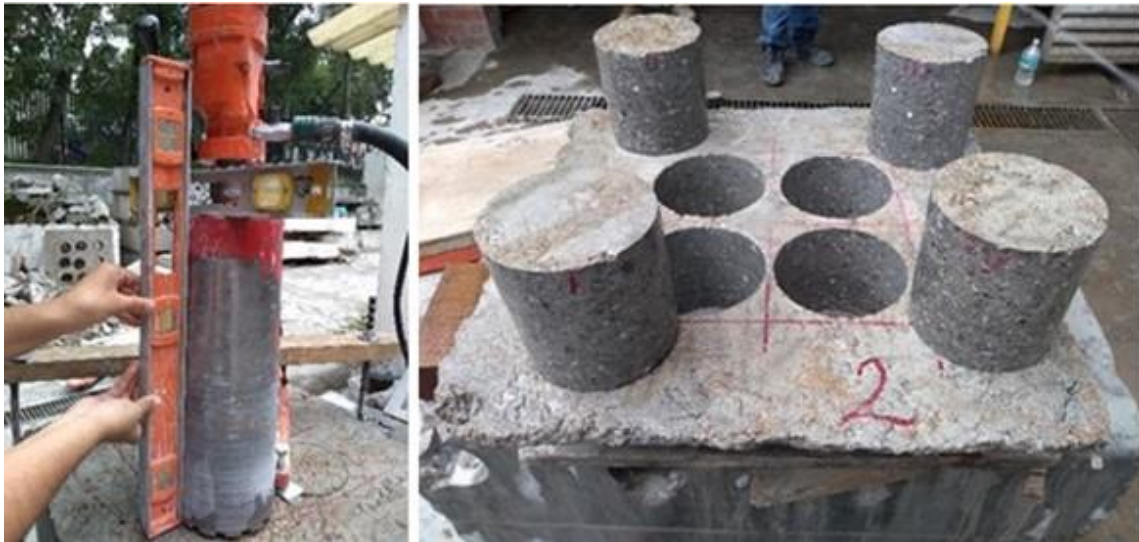
Figura 10. Extração de testemunhos para o ensaio de Barcelona.
