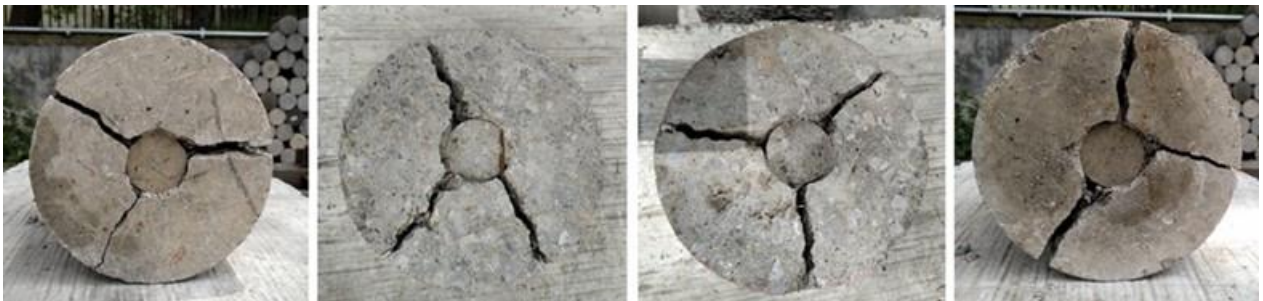
Figura 12. Modo de falha típico de cilindros, Ensaio de Barcelona.
