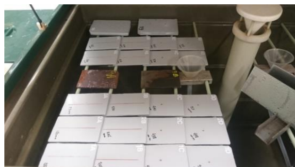
Figura 6. CPs en cámara salina antes da exposición a niebla (Ribeiro Filho, 2018)
