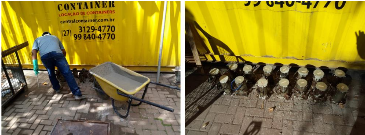
Figura 6. Detalle de los moldes de probetas cilíndricas en el vaciado del prototipo para ensayos de resistencia a la compresión y módulo de elasticidad.
