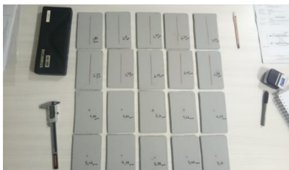
Figura 5. CPs con daños experimentales a la película (Ribeiro Filho, 2018)
