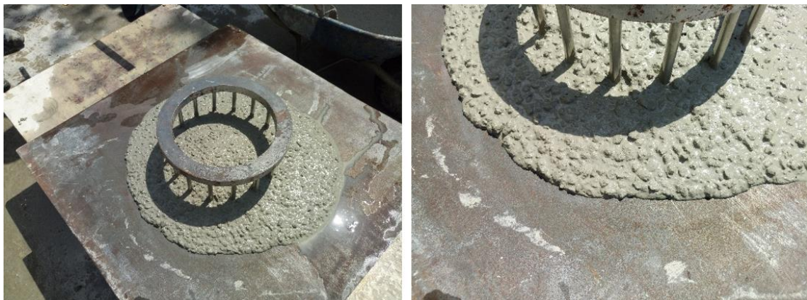
Figura 5. Detalle del ensayo de habilidad pasante a través del anillo J, realizado en laboratorio durante el estudio de dosificación.
