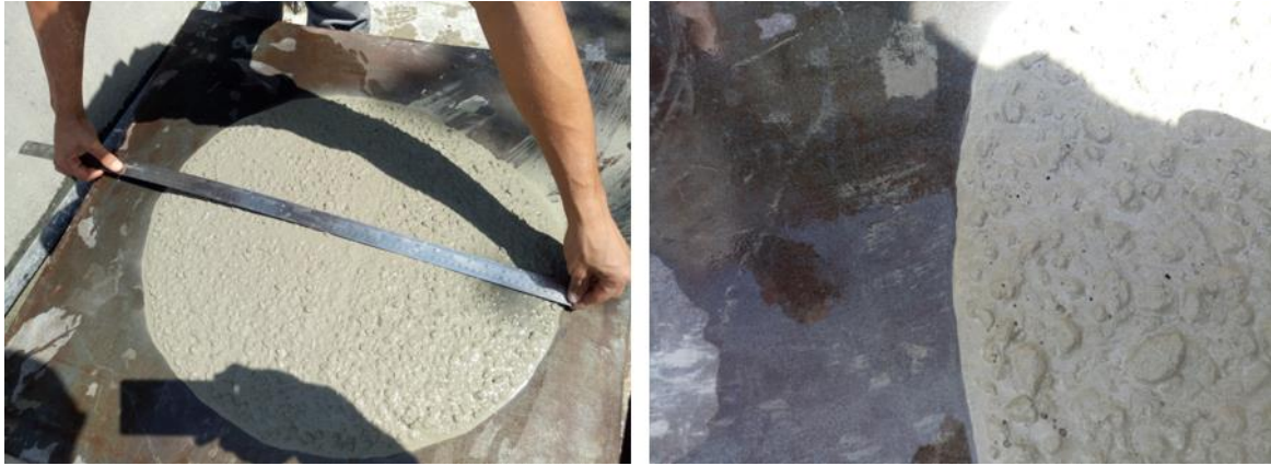
Figura 3. Detalle del ensayo de dispersión realizado en laboratorio durante el estudio de dosificación.
