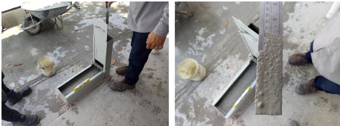
Figura 4. Detalle del ensayo de habilidad pasante a través de la caja L, realizado en el laboratorio durante el estudio de dosificación.
