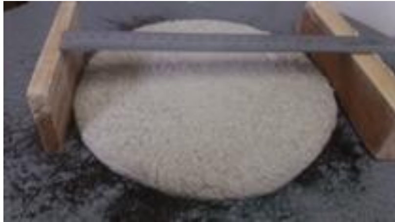
Figura 3. Verificación del esparcimiento para determinar la consistencia de compuestos cementosos.
