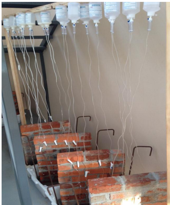
Figura 4. Aplicación de bloqueadores químicos.
