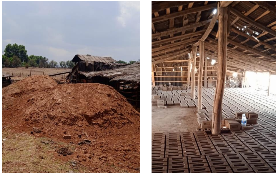
Figura 3. (a) Banco de suelo arcilloso precursor de Santiago Undameo; (b) Producción y elaboración de componentes de construcción.
