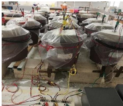
Figura 2. Configuração experimental usada para realcalinização eletroquímica.
