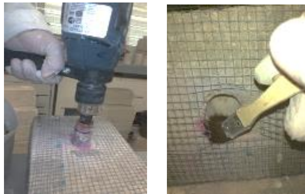
Figura 3. Extração de testemunhos e amostras de pó.
