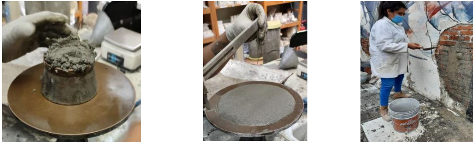
Figura 3. Ensayos en las mezclas de mortero: (a) Moldeado; (b) Consistencia; (c) Adherencia.
