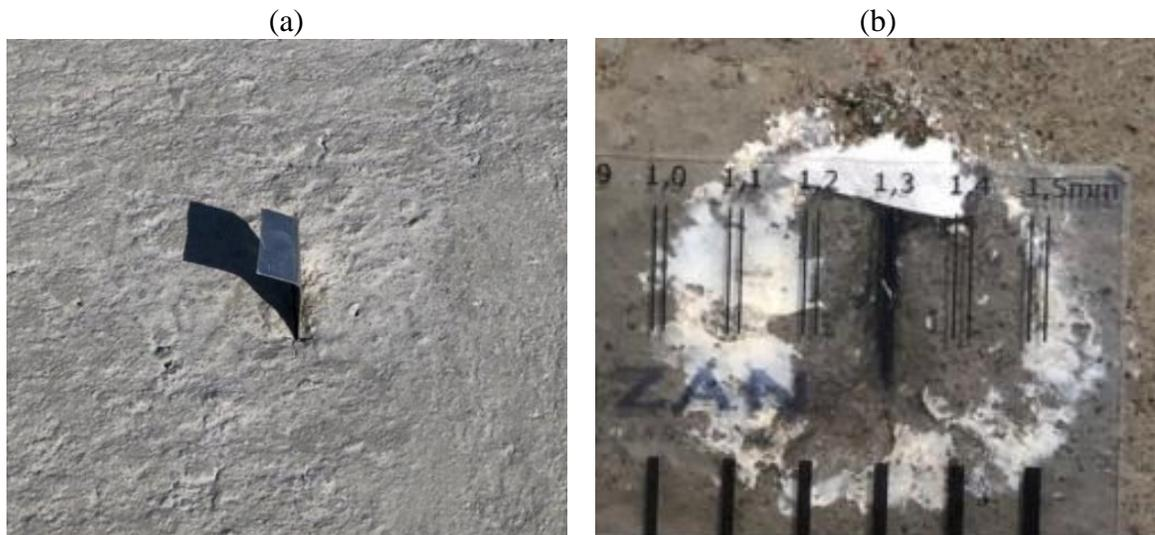
Figura 11. Fissuras: (a) Fissura ainda com a lâmina, (b) Fissura após a retirada da lâmina
