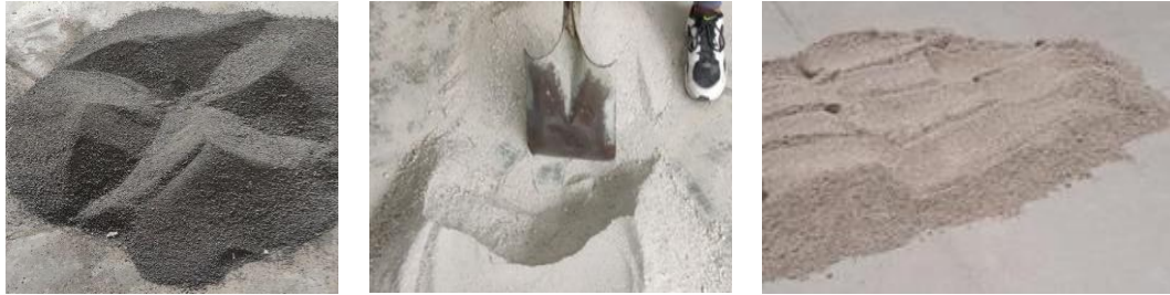
Figura 1. Arenas: (a) Arena volcánica de Joyitas (J); (b) Arena limosa de El Coro (CH); (c) Arena de río de El Cuervo (R). Fuente: (Durán, 2021; Durán, 2021; Mondragón, 2021).
