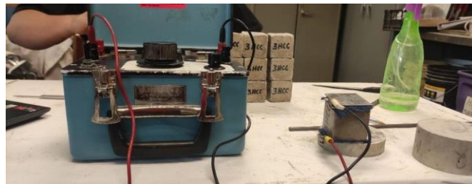
Figura 4. Equipo de resistividad eléctrica Nillson 400.
