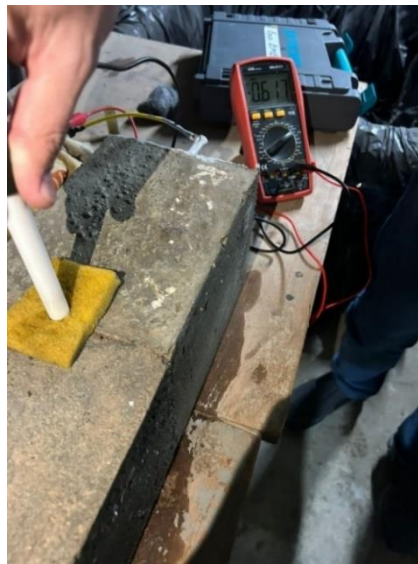
Figura 5. Aparatos para la realización de ensayos de potencial de corrosión ( E_{corr} ).
