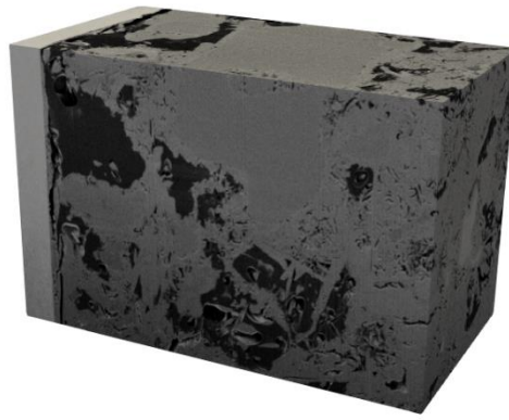
Figura 4. Nanotomografía MEV-FIB de la estructura de poros en la interfaz acero-concreto (Ruffray et al. , 2023).
