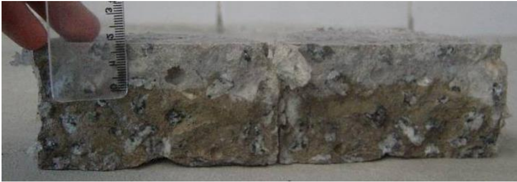
Figura 2. Posible precipitación de cloruros libres (blanco) y cloruros combinados (marrón) (Medeiros et al, 2009).
